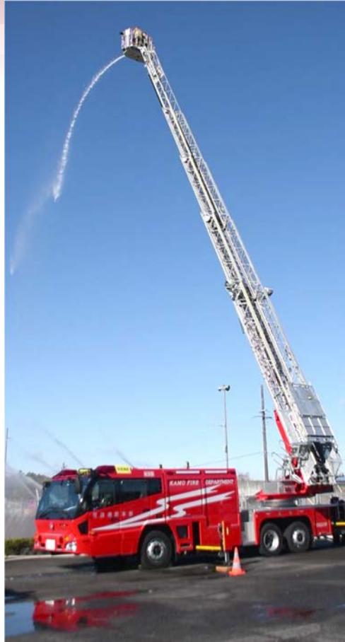
はしご車による放水(中消防署)
