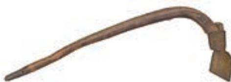
幅十センチくらいの片刃の鉄の刃に、先が内側に大きく曲がった独特の柄が付けられています。柄は、木の枝や細い幹を火であぶって曲げたり、湯で煮て曲げたりしました。
